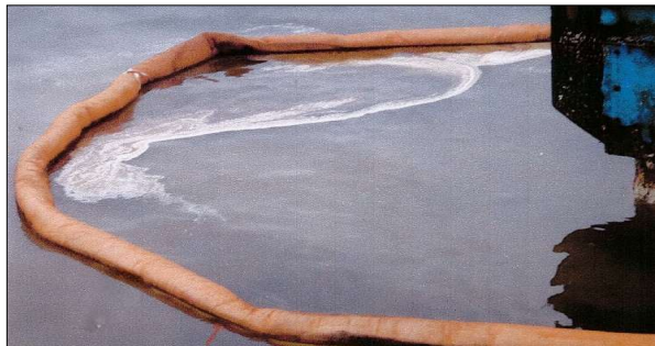
スカート下部は垂直になっており、流出油を包囲しながら吸着している
